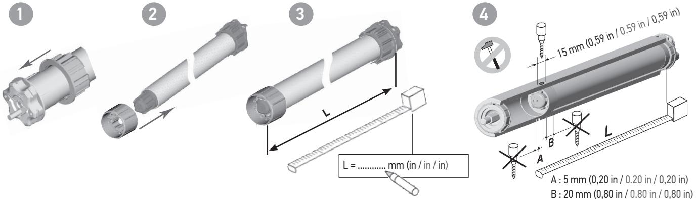
**3****ES** Instalación del tubo sobre sus soportes**PT** Instalar o tubo nos respectivos suportes**EL** Εγκατάσταση του σωλήνα στα στηρίγματά του
