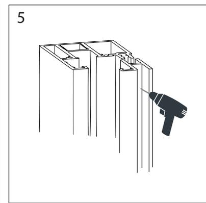
4 - Posizionare i tappi sul lato inferiore di entrambe le guide **a** (guide parallele disegno) e avvitarli
