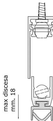
**Funzione:** chiusura automatica della fessura tra porta e pavimento per eliminare spifferi d'aria, infiltrazioni di polvere, insetti, fumo e per ridurre il passaggio di rumore
